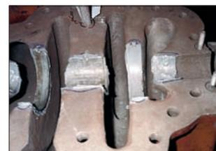
КерамАллой СП+АС после смешения приобретает консистенцию пасты, поэтому его легко наносить. При этом после отверждения КерамАллой СП+АС становится твердой, как металл, структурой, сходной с керамикой.
